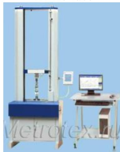
Рисунок 2 – Общий вид машин испытательных универсальных МТ 120
