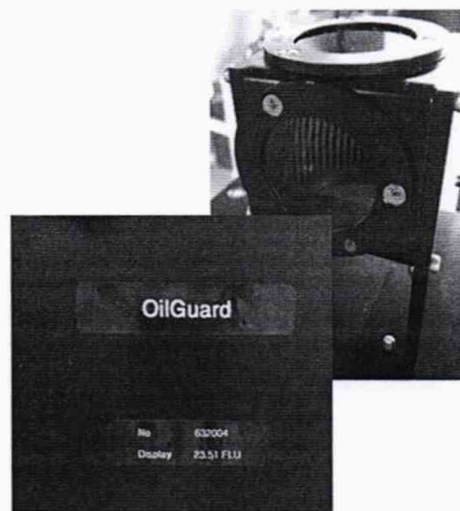
Рисунок 1 - Контрольный блок (светофильтр для проверки калибровки) анализаторов OilGuard 2Ex
