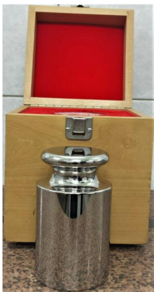
Рисунок 1 – Общий вид гирь 5 кг и 20 кг класса точности E_2
