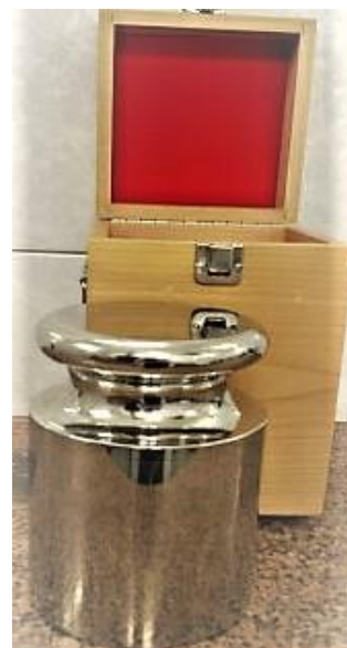
Рисунок 1 – Общий вид гирь 5 кг и 20 кг класса точности E_2
