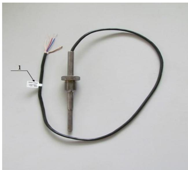
Рисунок 5 – Внешний вид термопреобразователей
