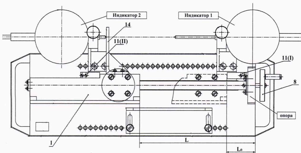
Рисунок 2 – Проверка наибольшего значения перемещения (хода) держателя образца
