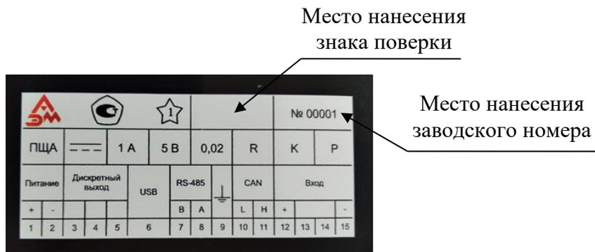
Рисунок 4 – Обозначение места нанесения знака поверки
