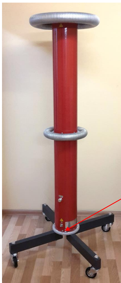
Рисунок 2 - Общий вид делителя напряжения ДН-160пт/2 и обозначение места пломбировки от несанкционированного доступа
