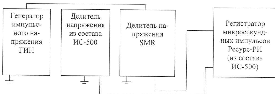
Рисунок 1 - Схема проверки относительной погрешности коэффициентов масштабного преобразования до 500 кВ
