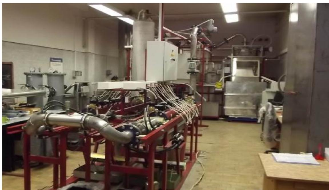
Рисунок 1. Внешний вид установки расходомерной УПРМ-С ТЕПЛОКОМ-100-0,05/0,1/0,25
