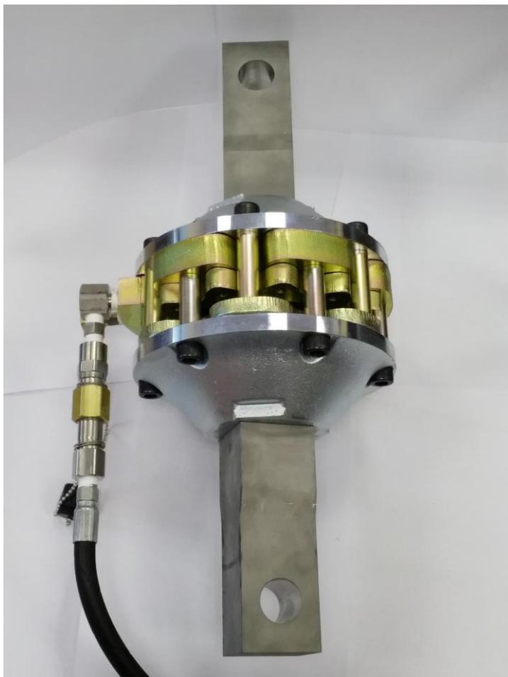
Рисунок 3 – Общий вид первичного гидравлического преобразователя.
