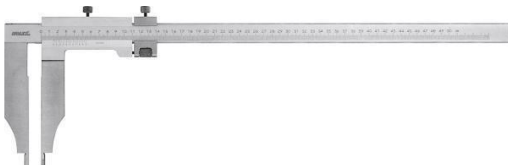
Рисунок 7 – Общий вид штангенциркулей исполнения ШЦ-III
