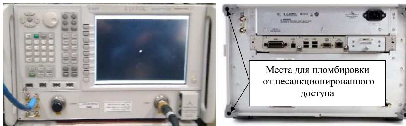
Рисунок 11 – Передняя и задняя панели векторного анализатора электрических цепей N5241A с указанием мест пломбировки от несанкционированного доступа
