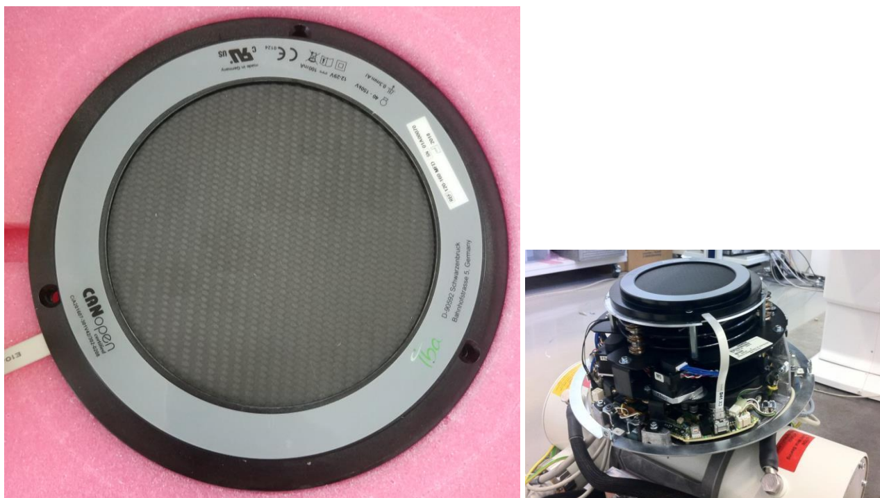
Рисунок 1 – Измеритель производства дозы на площадь KermaX plus 120-160 MFD (вид сверху и размещение на диафрагме коллиматора рентгенографической установки)
