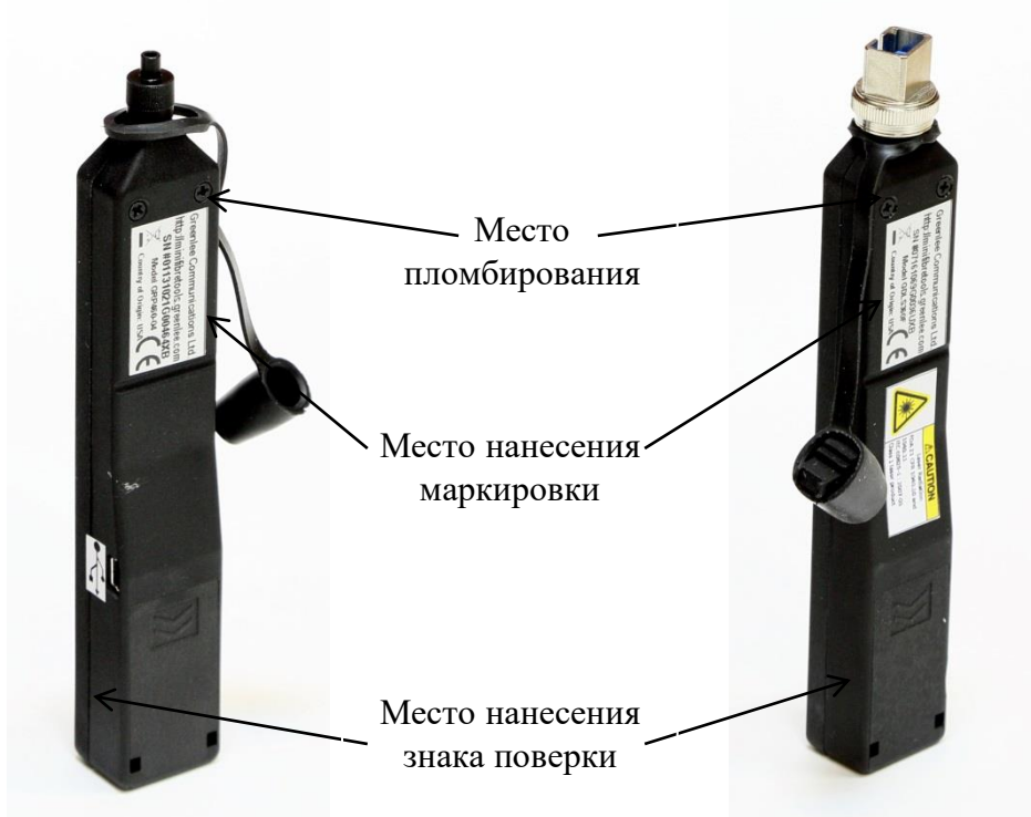
Рисунок 3 – Схема пломбировки от несанкционированного доступа, обозначение места нанесения знака поверки и маркировки
