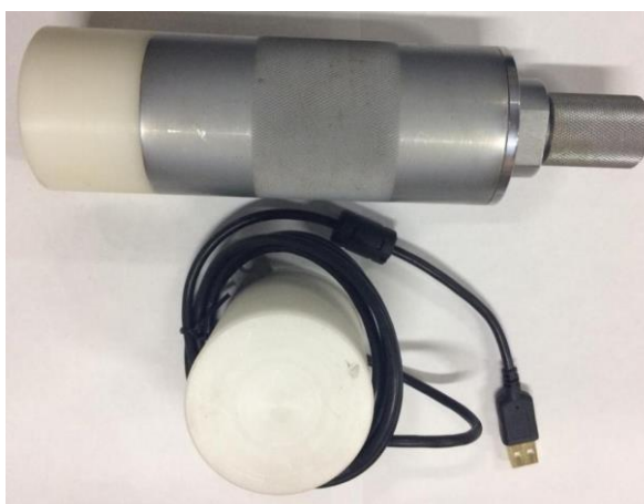
Рисунок 2 - Общий вид манометров-термометров АЦМ-УР
