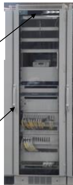
Рисунок 22 – Места расположения наклеек и запираания стойки приборной ИС-П1
