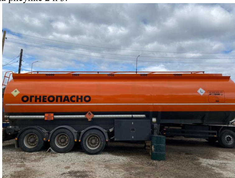
Рисунок 1 – Общий вид полуприцепа-цистерны для жидких нефтепродуктов ALI RIZA USTA
