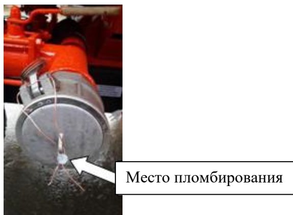
Рисунок 2 – Пломбировка трубопровода слива-налива
