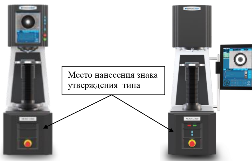
Рисунок 5 – Общий вид твердомеров Бринелля NEXUS 3300, NEXUS 3300M
