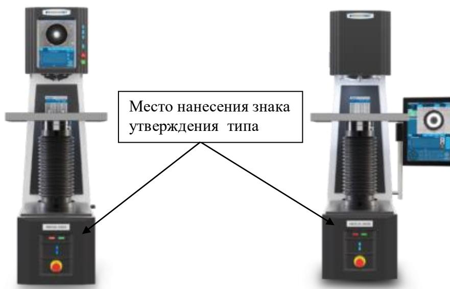
Рисунок 7 – Общий вид твердомеров Бринелля NEXUS 3400, NEXUS 3400M
