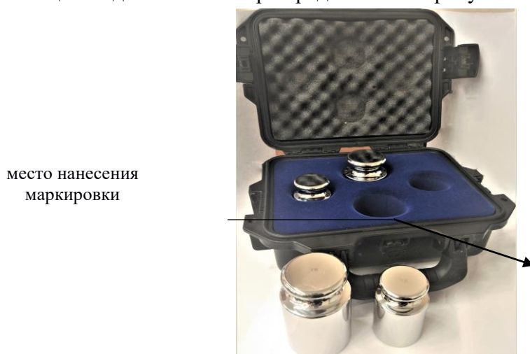
Рисунок 1 – Общий вид комплекта гирь класса точности E 2
