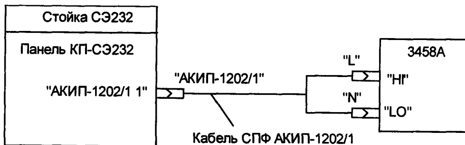
Рисунок Г.9 - Схема рабочего места для определения допустимой относительной погрешности воспроизведения напряжения переменного тока в диапазоне от 60 до 250 В
