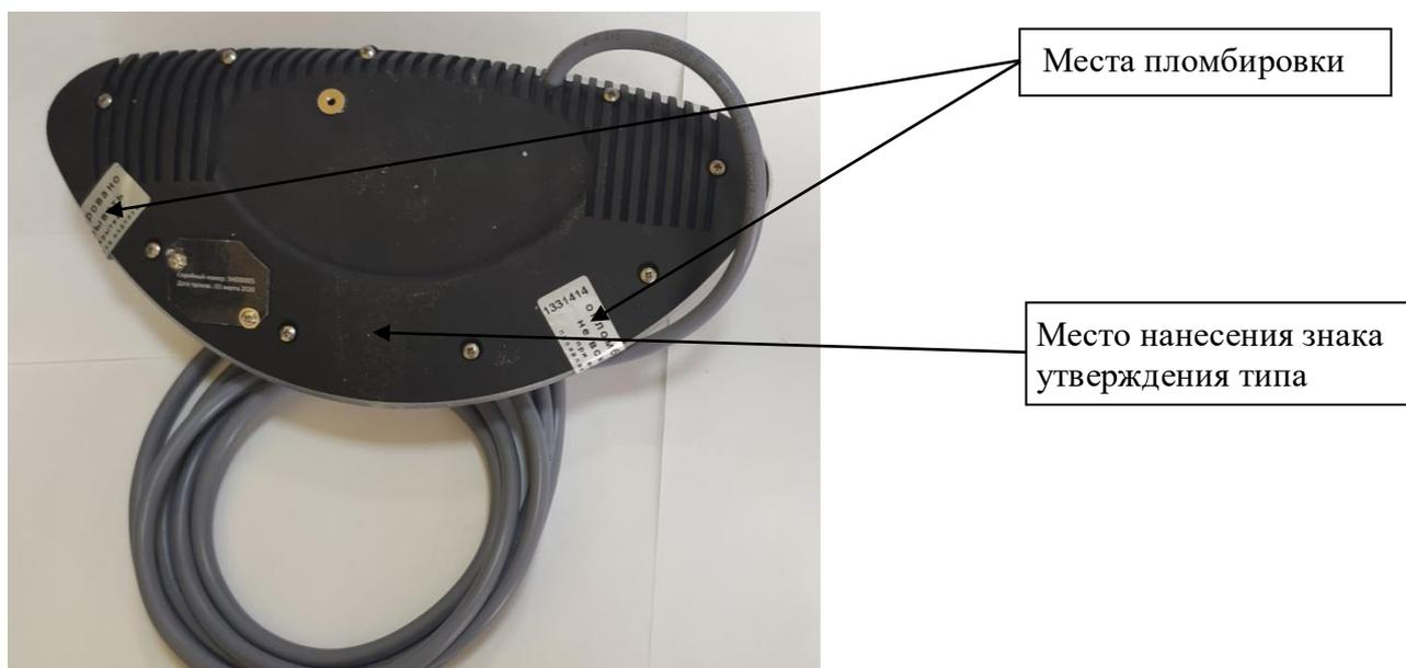
Рисунок 2 – Места нанесения знака утверждения типа и пломбировки от несанкционированного доступа блока
