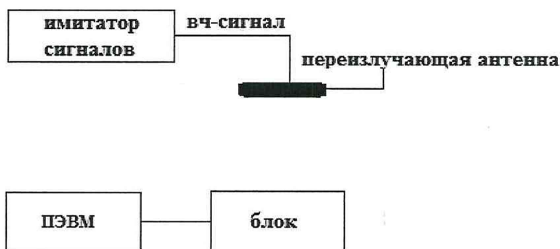
Рисунок 1 - Схема проведения измерений при опробовании, определении абсолютных инструментальных погрешностей определения координат местоположения и скорости
