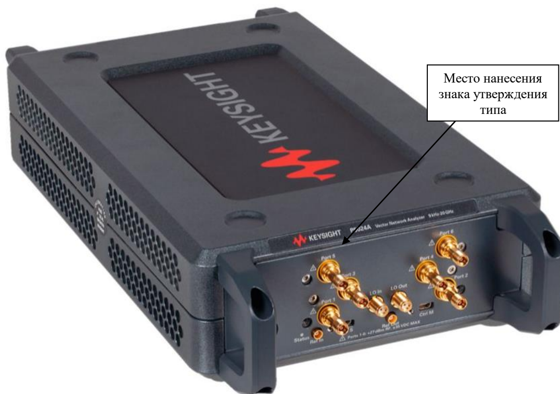
Рисунок 5 – Общий вид внешней панели анализаторов P5020A, P5021A, P5022A, P5023A, P5024A с опцией 600
