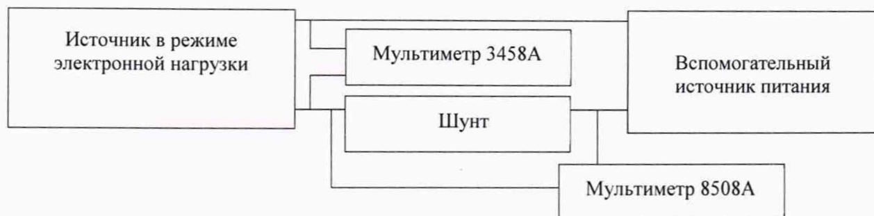
Рисунок 7 – Структурная схема определения приведенной (к номинальному значению) погрешности установки электрической мощности
