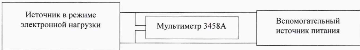
Рисунок 5 – Структурная схема определения приведенной (к номинальному значению) основной погрешности установки напряжения постоянного тока
