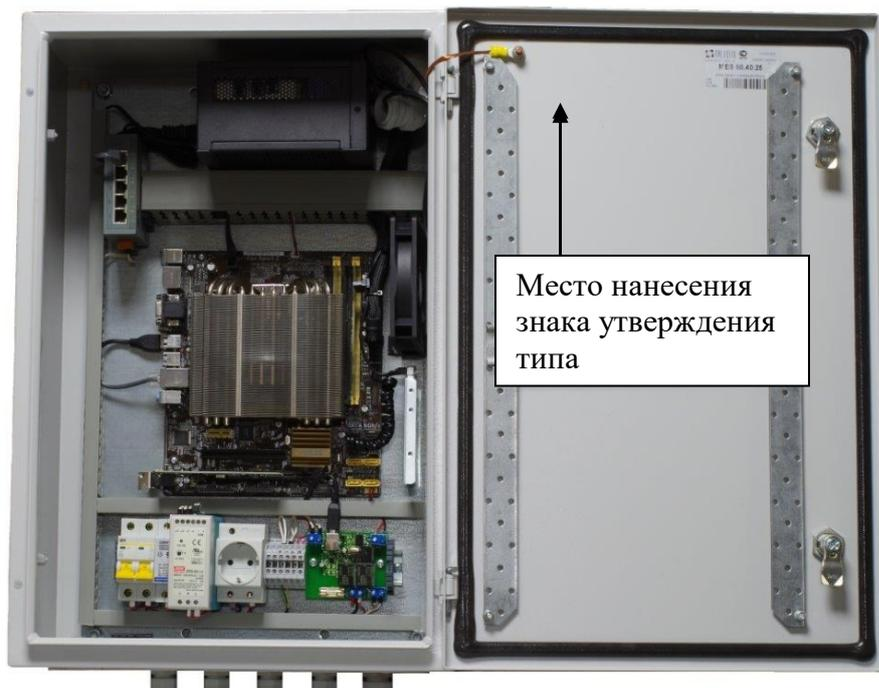
Рисунок 2 – Место нанесения знака утверждения типа
