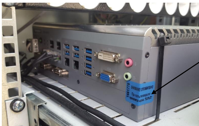
Рисунок 5 – Схема пломбировки от несанкционированного доступа модуля обработки и управления
