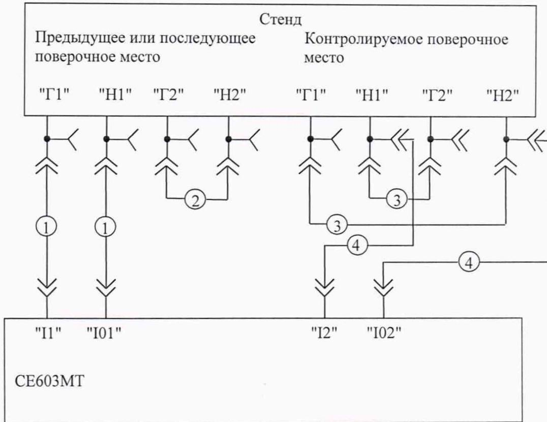
1 - Кабель 120 А с наконечниками 6 мм из комплекта ЗИП ваттметра-счетчика СЕ603М1.3.
