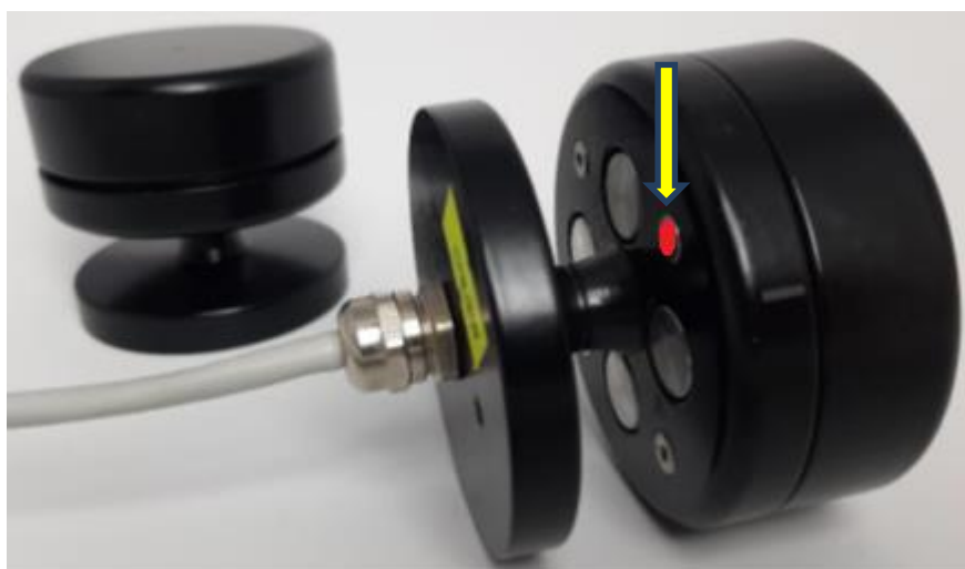
Рисунок 2 – Место пломбирования анемометров ультразвуковых СОКОЛ-УЗ
