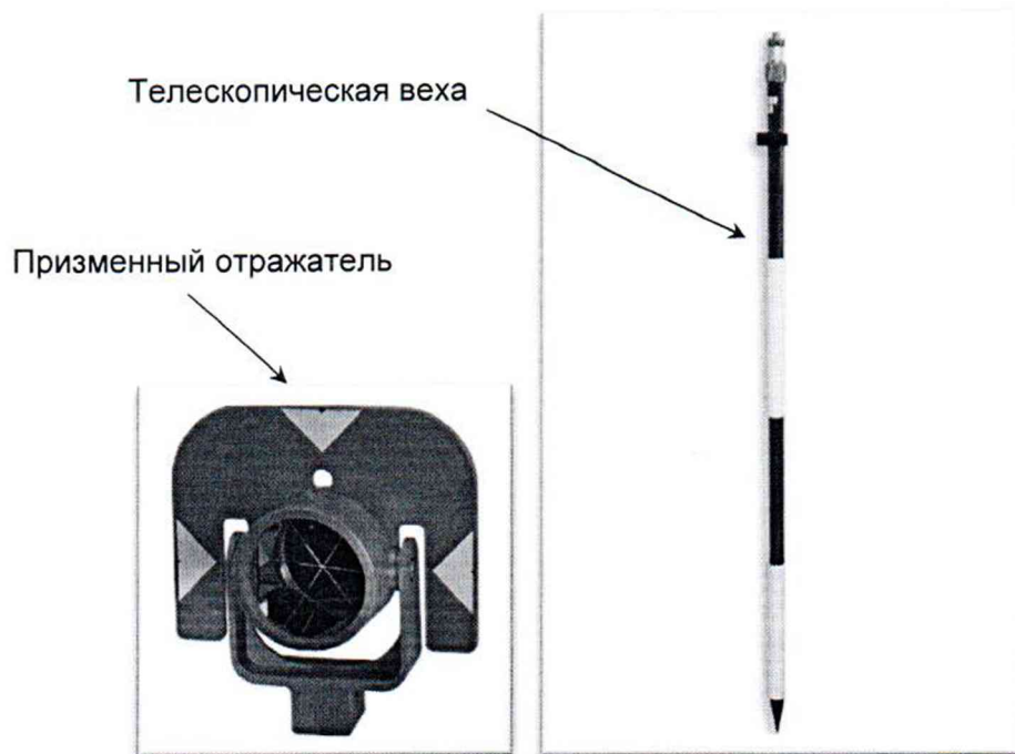
Рисунок А.1 – Веха телескопическая с призмальным отражателем
