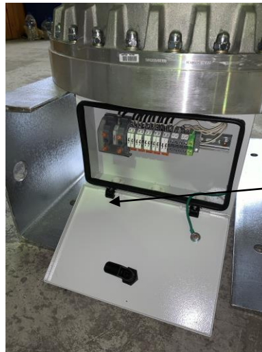
Рисунок 2 – Схема пломбирования вторичных выводов вторичных обмоток
