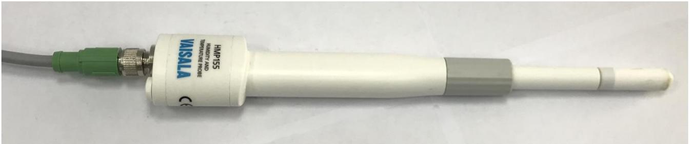
Рисунок 1 – Общий вид датчика HMP155
