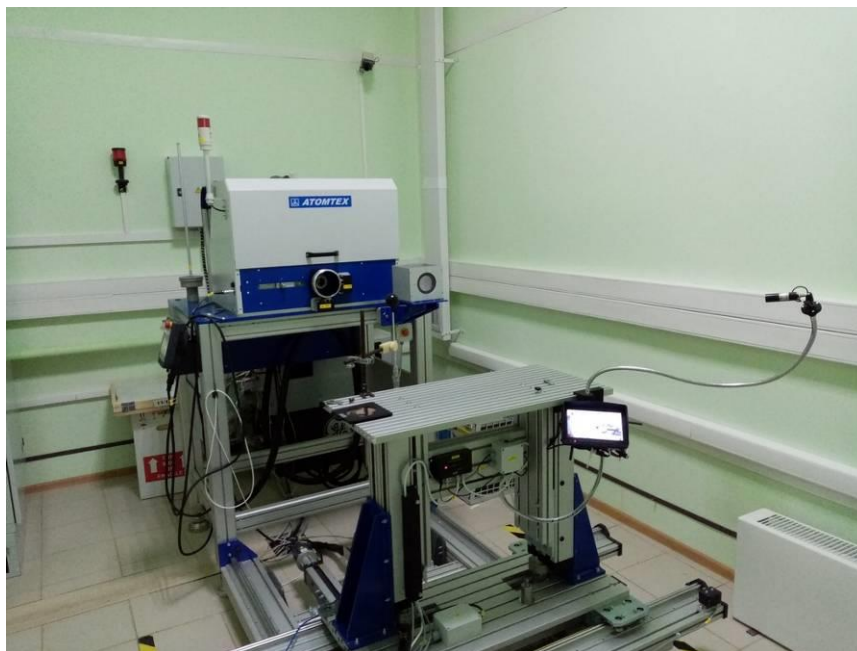
Рисунок 1 – Общий вид установки поверочной рентгеновского излучения УПР-АТ300
