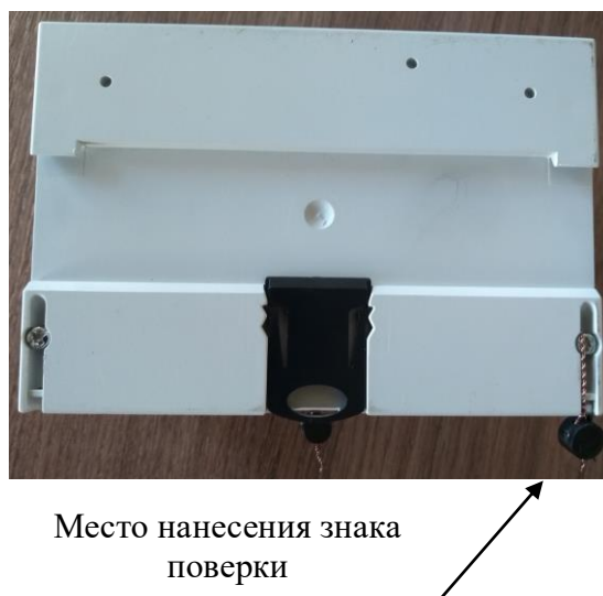
Рисунок 2 - Общий вид счётчиков с установкой на DIN-рейку с указанием места нанесения знака поверки со снятой крышкой клеммной колодки
