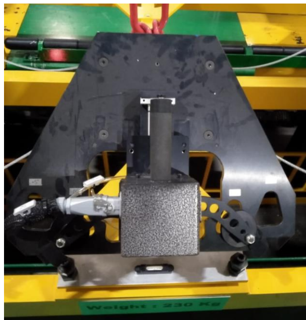
Рисунок 2 - Устройство угломерное с калибровочным приспособлением
