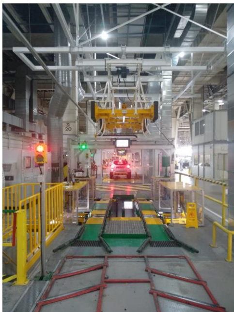
Рисунок 1 - Общий вид устройства для измерений углов установки колес автомобилей FORI модель FNCA-3DGT
