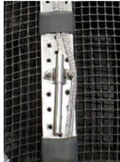
Рисунок 12 – Преобразователь терморезистивный ДТС214. Вид внешний
