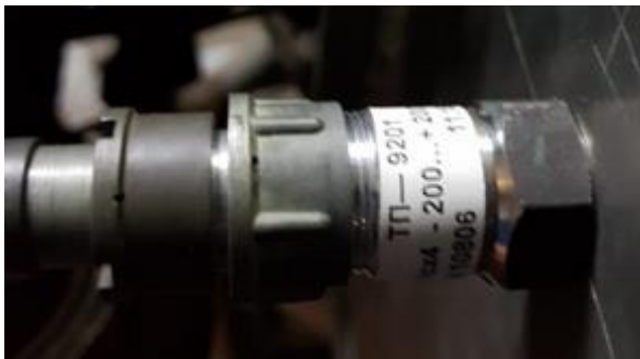
Рисунок 13 – Преобразователь терморезистивный ТП-9201. Вид внешний
