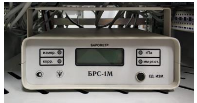
Рисунок 14 – Барометр рабочий сетевой БРС-1М. Вид внешний
