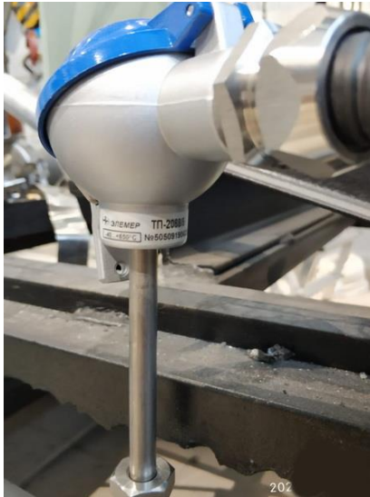
Рисунок 11 – Преобразователь термоэлектрический ТП-2088. Вид внешний
