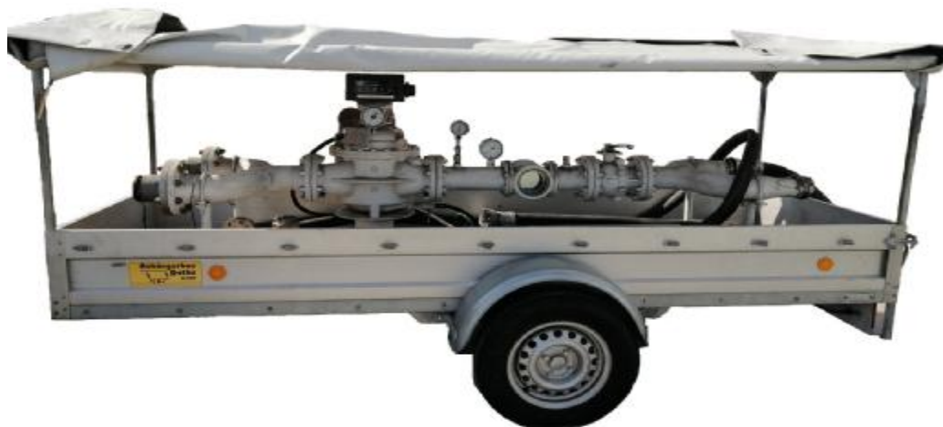
Рисунок 1 – Общий вид установки поверочной передвижной для счетчиков нефтепродуктов УППСНЭ-1М
