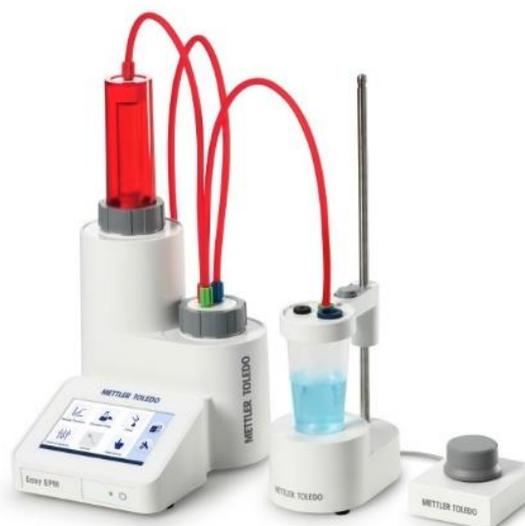
Рисунок 2 - Общий вид дозатора Easy EPM
