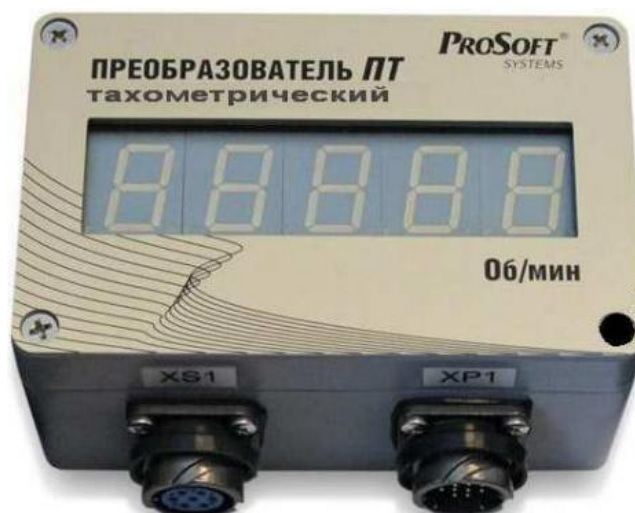
Рисунок 6 – Преобразователь тахометрический ПТ
