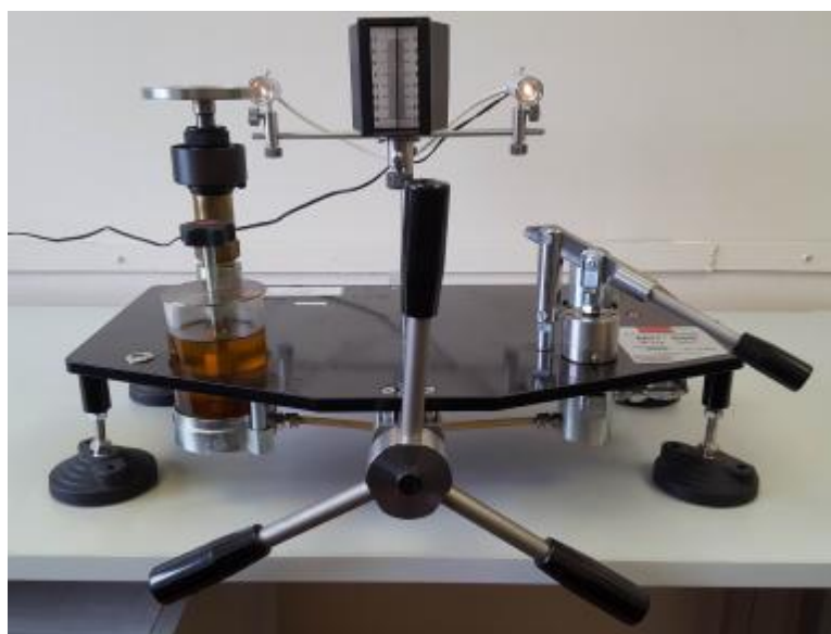
Рисунок 1 – Общий вид манометра грузопоршневого МП-60
