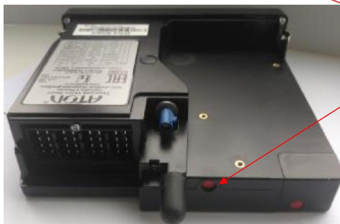
Места пломбировки от несанкционированного доступа
