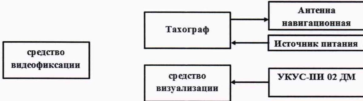
Рисунок 5 - Схема проведения измерений при определении абсолютной погрешности синхронизации шкалы времени внутреннего опорного генератора тахографа со шкалой времени блока СКЗИ
