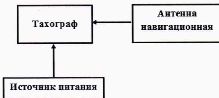
Рисунок 1 – Схема проведения измерений при опробовании
