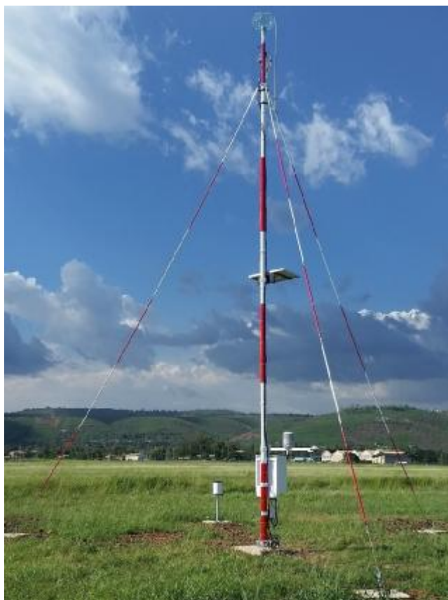
Рисунок 1 – Общий вид метеостанции AWS310-SITE
