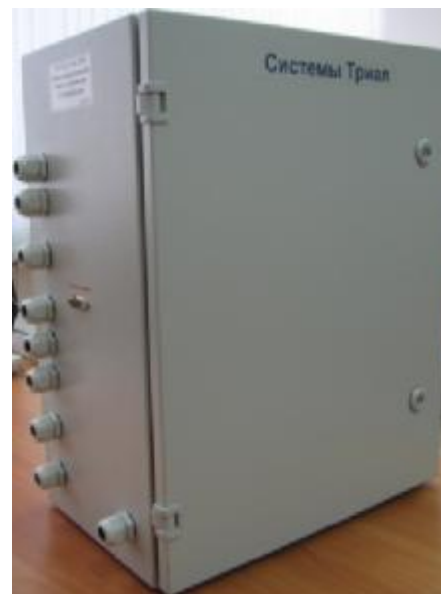
Рисунок 2 – Шкаф измерительный тока и напряжения
