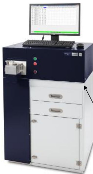
Рисунок 4 - Общий вид спектрометра оптико-эмиссионного FOUNDRY-MASTER OE750
