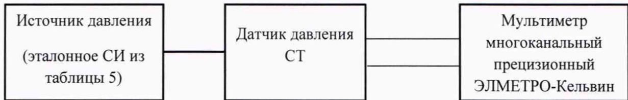
Рисунок А.1 – Структурная схема проверки датчика с аналоговым выходным сигналом
