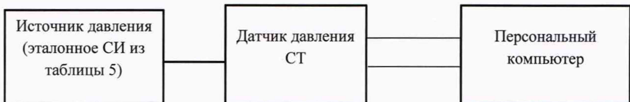
Рисунок А.2 – Структурная схема проверки датчика с цифровым выходным сигналом
