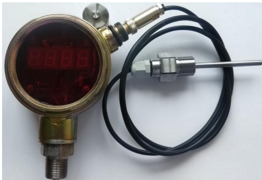
Рисунок 3 - Манометр-термометр устьевого Фотон-И в исполнении с внешним датчиком температуры
