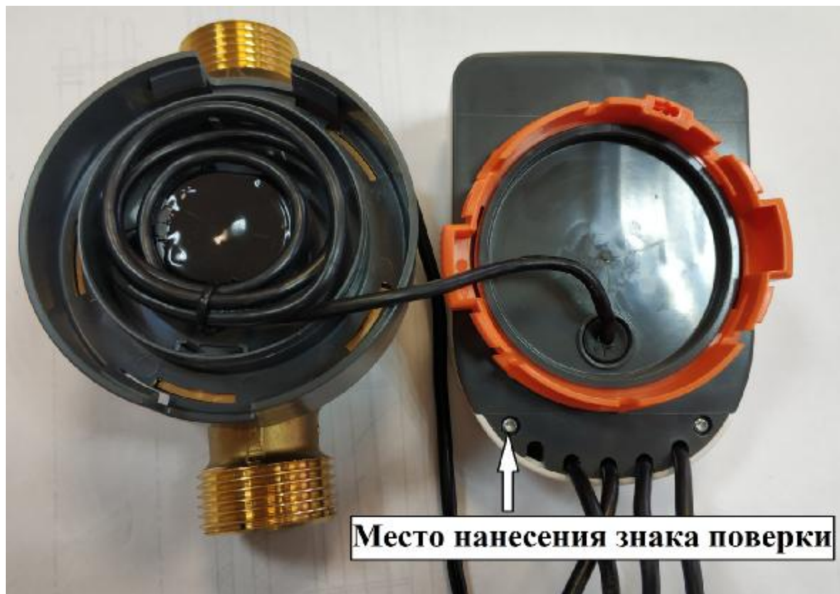
Рисунок 2 – Схема пломбировки от несанкционированного доступа, обозначение места нанесения знака поверки
