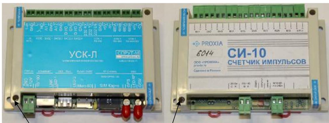
Место пломбировки от несанкционированного доступа
