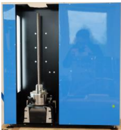
Рисунок 3 - Общий вид приборов для измерений геометрических параметров образцов арматуры модификации RM 603
