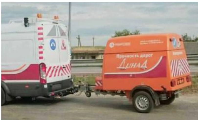
Рисунок 4 - Общий вид комплексов измерительных передвижных дорожных лабораторий ТРАССА 2 с прицепным устройством ДИНА 4 FWD
